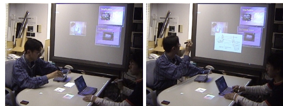
図 9: Pick-and-Beam: レーザーポインタによる情報転送
